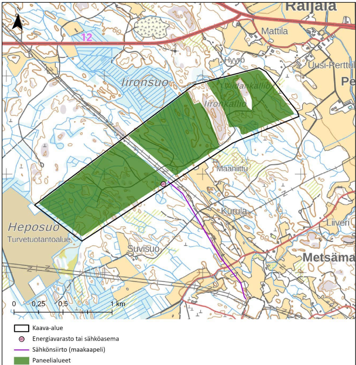
Kuva 7.1. Karsitun aurinkovoimalan yleispiirteinen suunnitelma.
