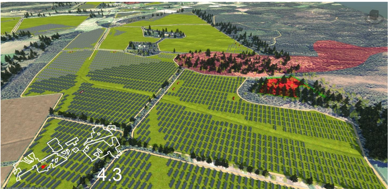
Kuva 39: Yläviistonäkymä Suvisuonojan paneelittomasta uoman suoja-alueesta.
